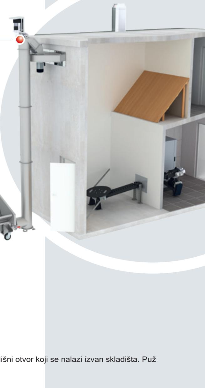
Takođe se isporučuje sa horizontalnim razdelnim pužem
