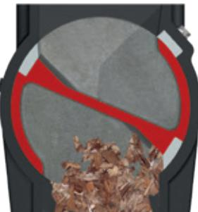
Dve velike komore (prečnika 200 mm rotora) su posebno pogodne za prevoz drvne sečke do P31S (prethodno G50). Visok otpor se prepoznae automatski. Rotacioni ventil i puž pomeraju se unazad (nekoliko puta u zavisnosti od postavljenih parametara) dok se transport ne može ponovo pokrenuti.
