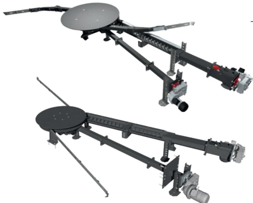
Frolingov kružni agitator za pražnjenje skladišta sa zasebnim pogonom nudi veću fleksibilnost od odtalih sistema. U varijanti FBR-G i TGR-G pogon kružnog agitatora je nezavisan od pogona dozirnog puža. To omogućava fleksibilnost prilikom montaže, kao promenljivo podešavanje izlaza napajanja. Dozirni kanal može se montirati levo ili desno u odnosu na kružni agitator.
