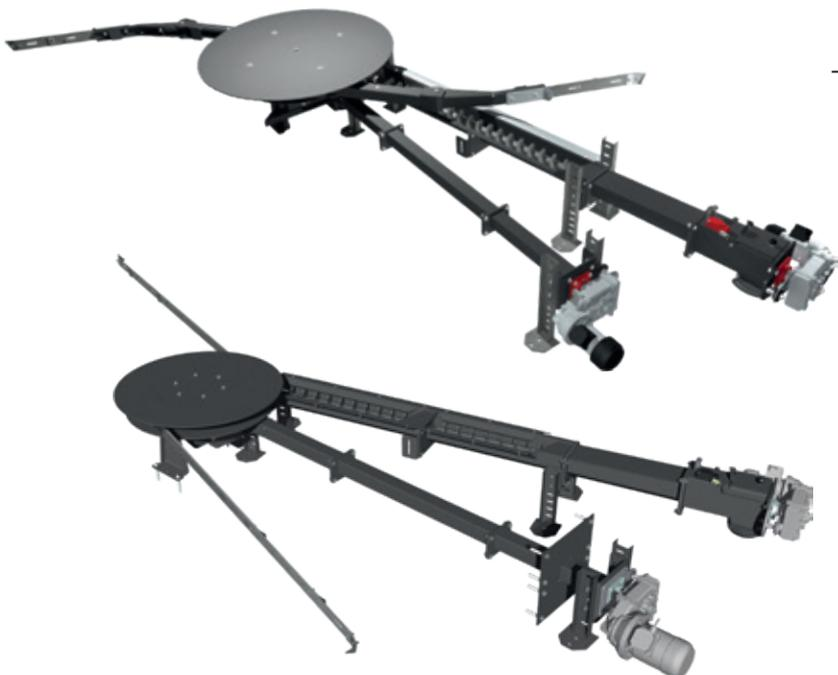
Frolovingov kružni agitator za pražnjenje skladišta sa zasebnim pogonom nudi veću fleksibilnost od ostalih sistema. U varijanti FBR-G i TGR-G pogon kružnog agitatora je nezavisan od pogona dozirnog puža. To omogućava fleksibilnost prilikom montaže, kao promenljivo podešavanje izlaza napajanja. Dozirni kanal može se montirati levo ili desno u odnosu na kružni agitator.
